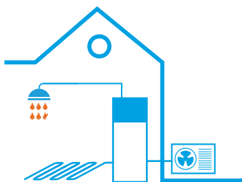
Unitate de pardoseală cu rezervor de apă caldă menajeră integrat
